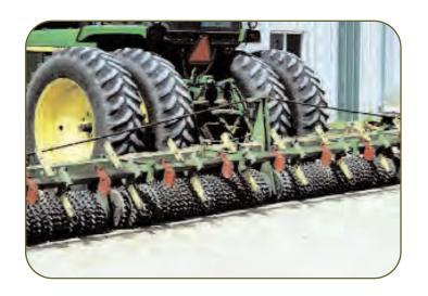
RUSLE2 - DRILL, SINGLE DISK OPENERS, 7-10 INCH SPACING
